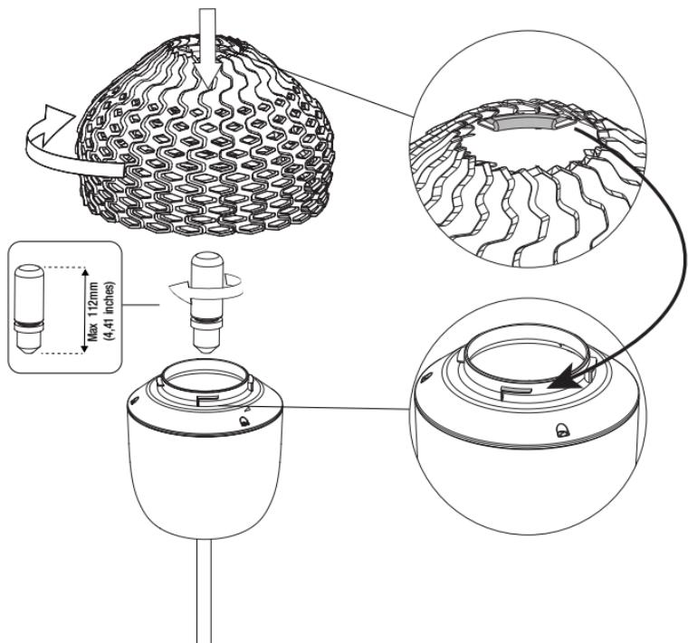
**IT** Fig.3 Montare il diffusore esterno sull'anello riflettore e bloccarlo con un movimento a baionetta in senso orario dopo aver introdotto le 4 guide del diffusore esterno nelle apposite sedi dell'anello riflettore.
