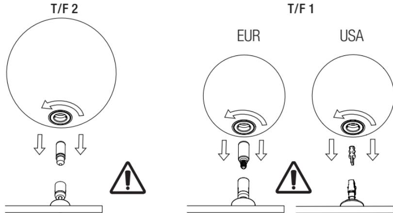
**IT** Fig.2 **⚠ ATTENZIONE :** Avvitare lentamente il diffusore avendo cura di non forzare l'operazione di serraggio. Un serraggio eccessivo può causare infatti difficoltà nell'operazione di smontaggio, rendendo necessario l'impiego di un utensile.
